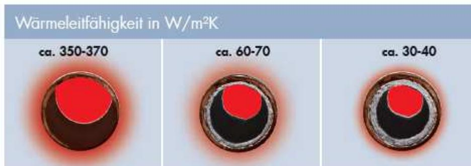
Rohr-Innendämmung: Ablagerungen in Rohren und Wärmetauschern stören den Wärmetransport.
